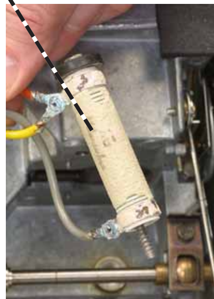
FIG. D27 The wirewound resistor.
